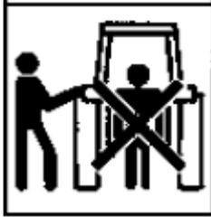
Lors de l'attelage des appareils et de l'actionnement du système hydraulique, personne ne doit se trouver entre les machines !
