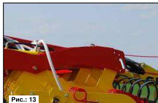
Два передних ряда зубьев разрыхляют луговую дернину. Задние ряды зубьев создают оптимальную поверхность для новых трав. Для более агрессивной работы передних зубьев (например, при тяжелых почвенных условиях) палец следует установить в одно из нижних отверстий. Для мягких почв или влажных условий можно использовать только задние зубья, для этого установите кулису в верхнее положение.
