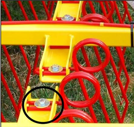
Abbildung 11: Mutter herunterschrauben
