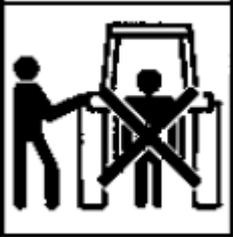
Beim Anhängen der Geräte und beim Betätigen der Hydraulik darf niemand zwischen den Maschinen stehen!
