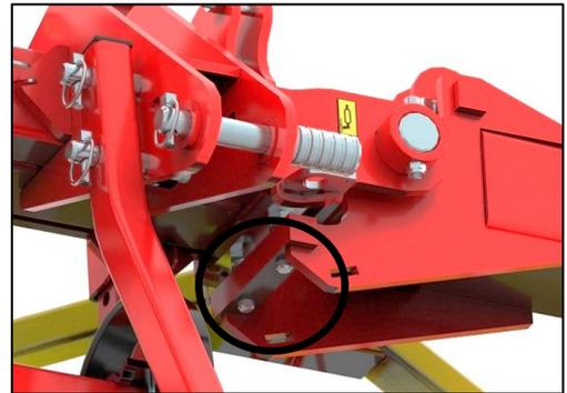
Abbildung 9: Anschlagsschrauben
