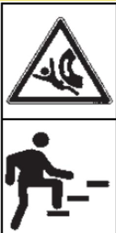
Ne pas monter sur des pièces en rotation ; utiliser les accès prévus !
