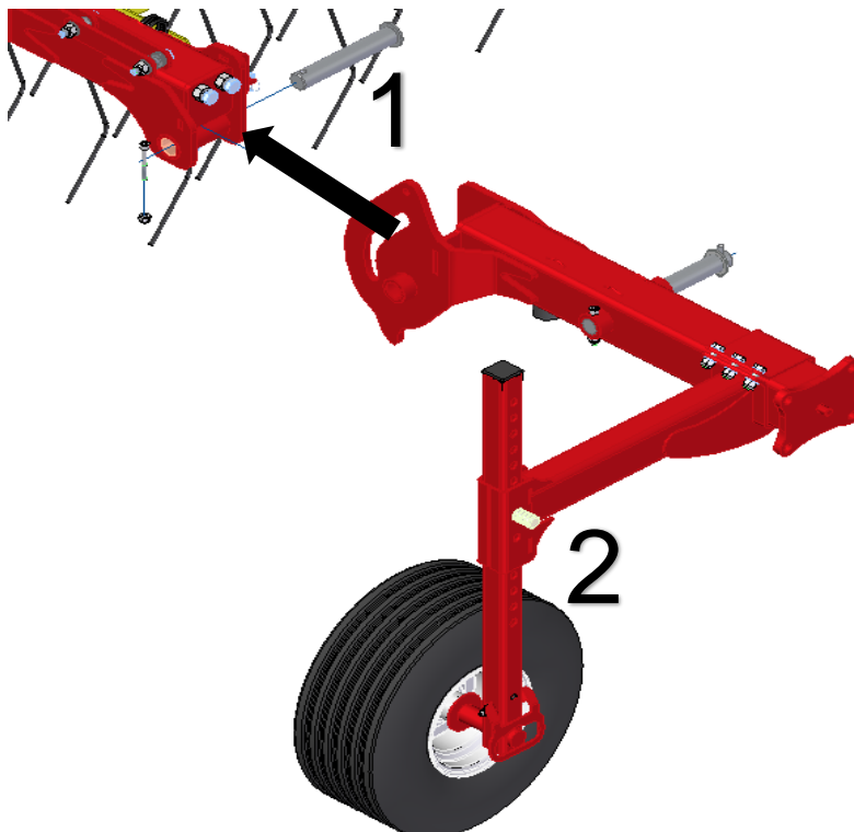
Abbildung 20: Montage Seitenrahmen am Hauptrahmen vom AS 900 M1 Scherenklappung
