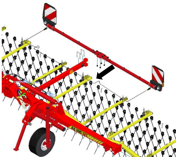
Abbildung 11: Montage Beleuchtung AS 600 M1
