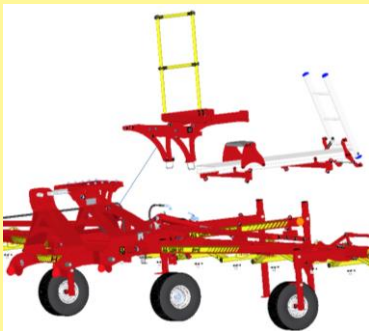
Abbildung 10: Montage des Plattformkits 1
