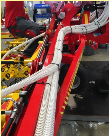
Abbildung 32: Schlauchverlegung entlang des Seitenrahmens
