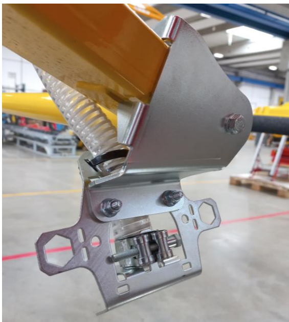
Abbildung 24: vollständig durchgeführte Prallblechmontage 3
