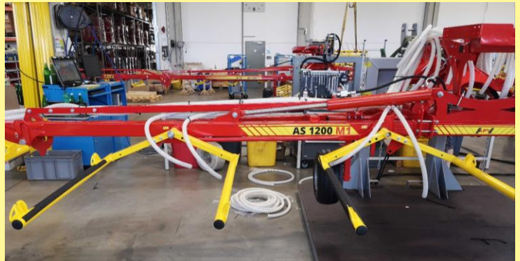
Abbildung 33: Schlauchverlegung über dem Drehpunkt des Striegelfeldes
