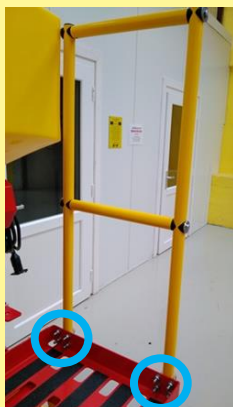
Abbildung 7: Geländer an der Trittpläche montiert
