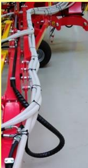
Abbildung 34: Schlauchführung entlang der Scherklappung
