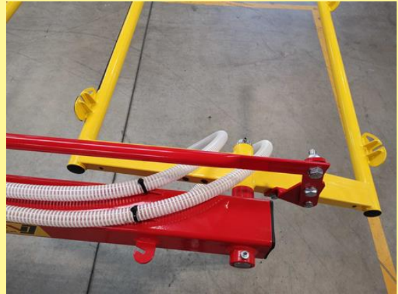
Abbildung 37: Schlauchverlegung über dem Drehpunkt des Striegelfeldes
