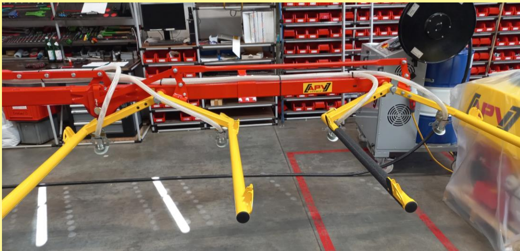
Abbildung 38: Schlauchverlegung zu den beiden äußersten Striegelfeldern
