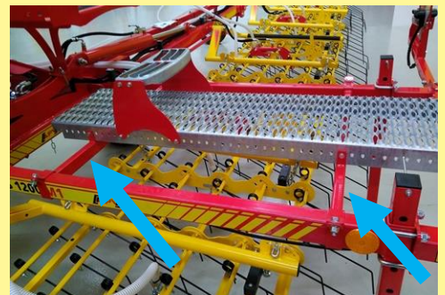
Abbildung 12: Plattformkit am Rahmen der Stützfüße montiert
