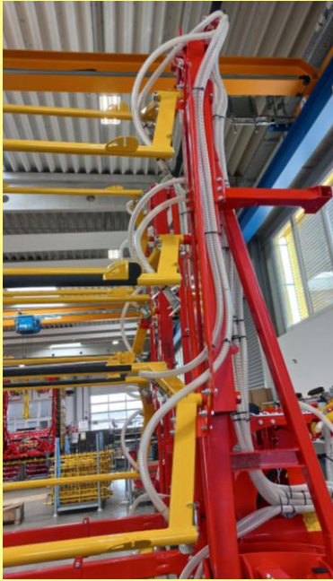
Abbildung 40: korrekte Prallblech- und Schlauchmontage 1
