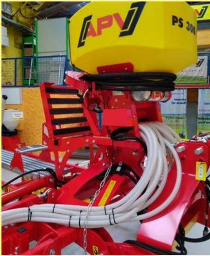
Abbildung 28: Schlauchverlegung vom PS ausgehend linke Seite
