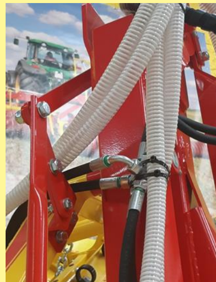
Abbildung 35: Befestigung der Schläuche bei der Scherklappung
