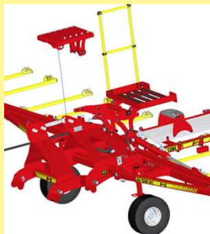
Abbildung 5: Montage der PS Halterung an den Anbaubock 1
