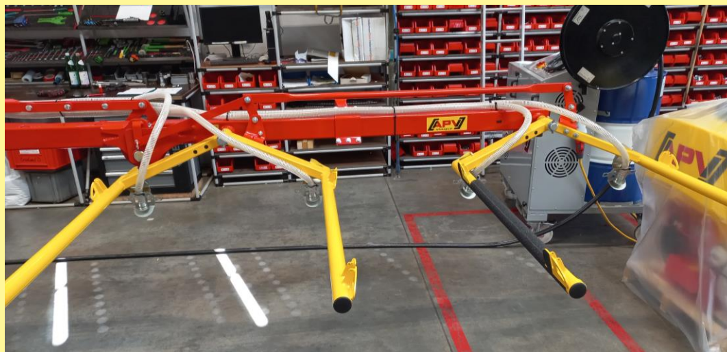
Figure 38 : Pose des flexibles vers les deux compartiments de herse extérieurs
