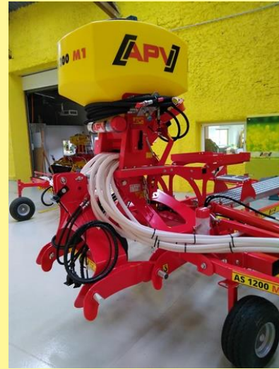
Figure 29 : pose de flexible en partant du PS côté droit
