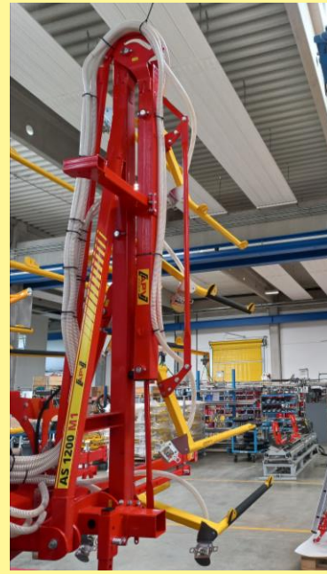
Figure 41 : Pose correcte des déflecteurs et des flexibles 2
