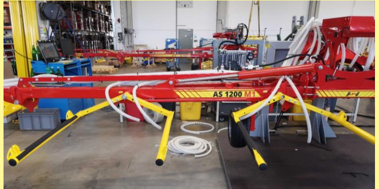
Figure 33 : pose de flexible via le point d'articulation du compartiment de herse
