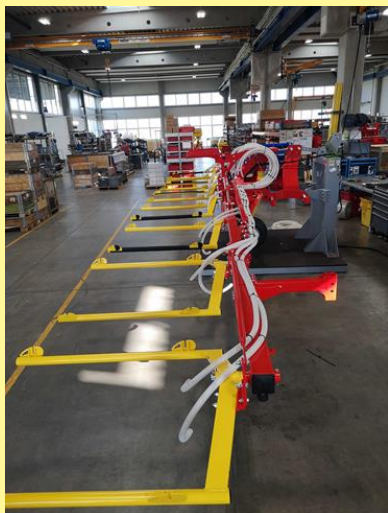
Figure 36 : pose de flexible vers les compartiments de herse extérieurs le long du cadre
