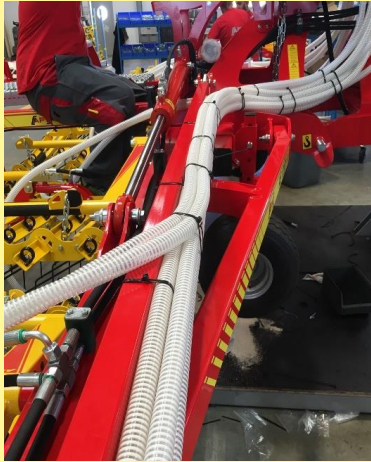
Figure 32 : pose de flexible le long du cadre latéral
