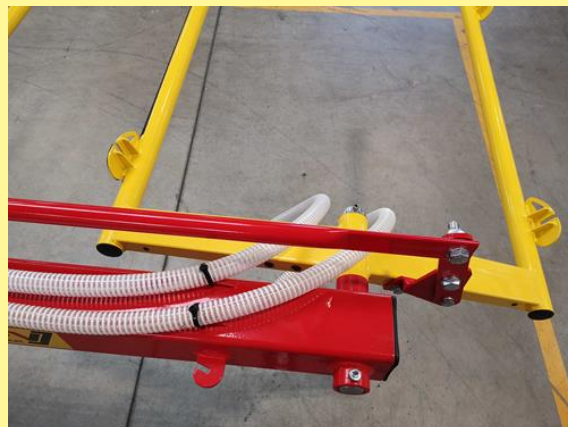
Figure 37 : pose de flexible via le point d'articulation du compartiment de herse
