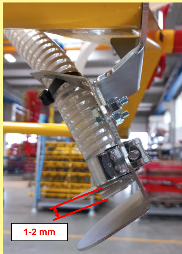
Figure 39 : disque d'épandage avec flexible entièrement monté
