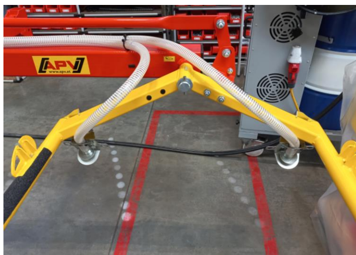
Figure 25 : Montage des déflecteurs terminé 4
