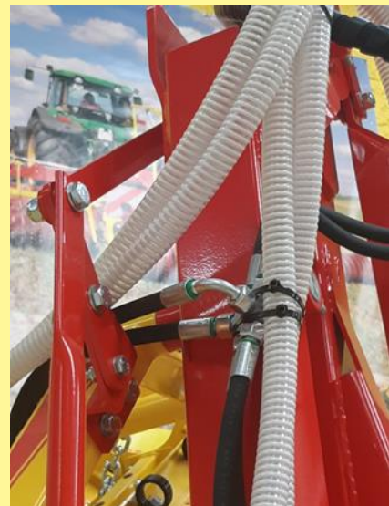
Figure 35 : fixation des flexibles en cas de pliage en ciseaux
