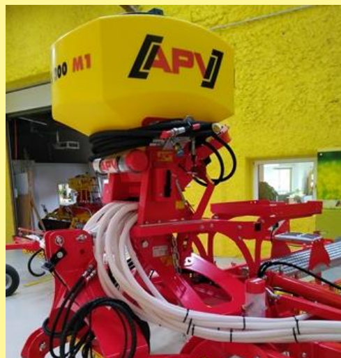
Figure 14 : montage du PS avec sorties de flexible dans le sens de marche
