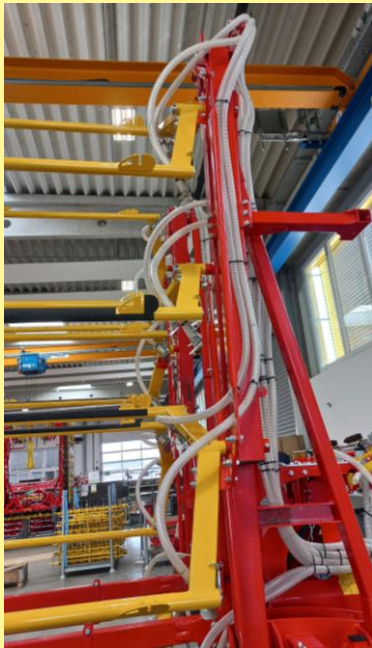
Figure 40 : Pose correcte des déflecteurs et des flexibles 1
