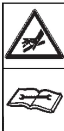
Будьте осторожны при выходе жидкости под давлением! Соблюдать указания из руководства по эксплуатации!
