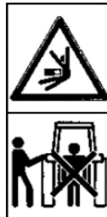
При навешивании агрегатов и приведении в действие гидравлики запрещено находиться между машинами!
