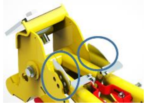
Figura 13 Lamiera montata per impedire un utilizzo erraneo
