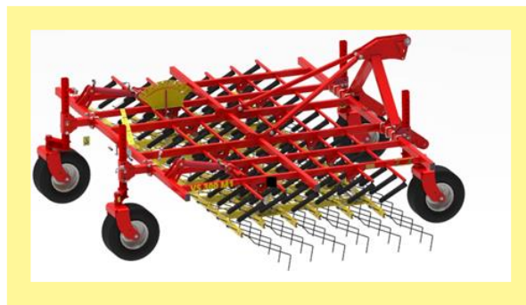
Fig. 11: Frontmontering med 4 dybdehjul
