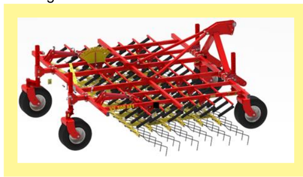
Afbeelding 11: frontaanbouw met 4 tastwielen
