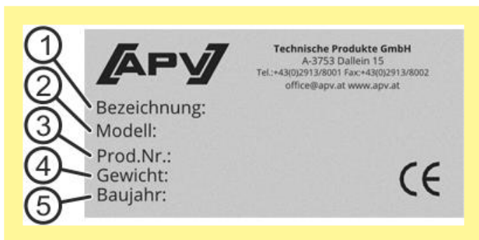
Afbeelding 2: opbouw van het typeplaatje
