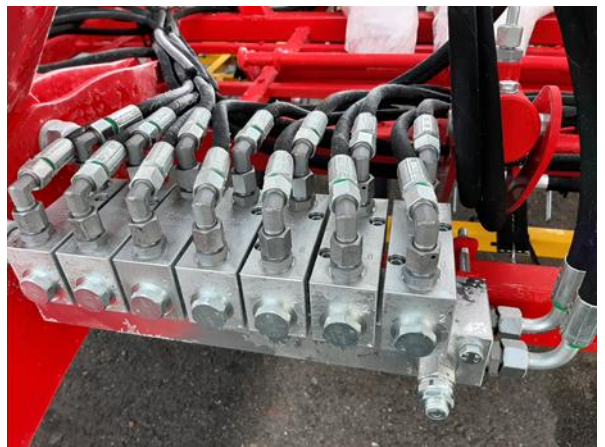
Figura 14: Divisor de flujo en el bastidor central
