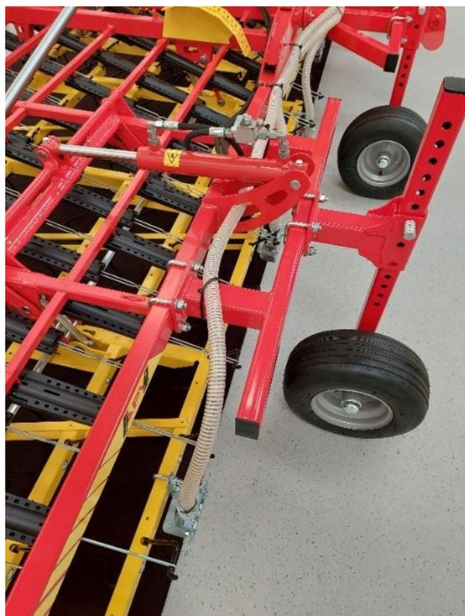
Figure 79 : pose des flexibles le long de la herse 6
