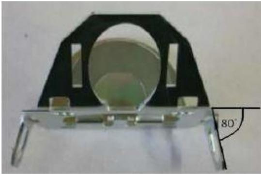
Figure 51 : pliage des attaches latérales des déflecteurs
