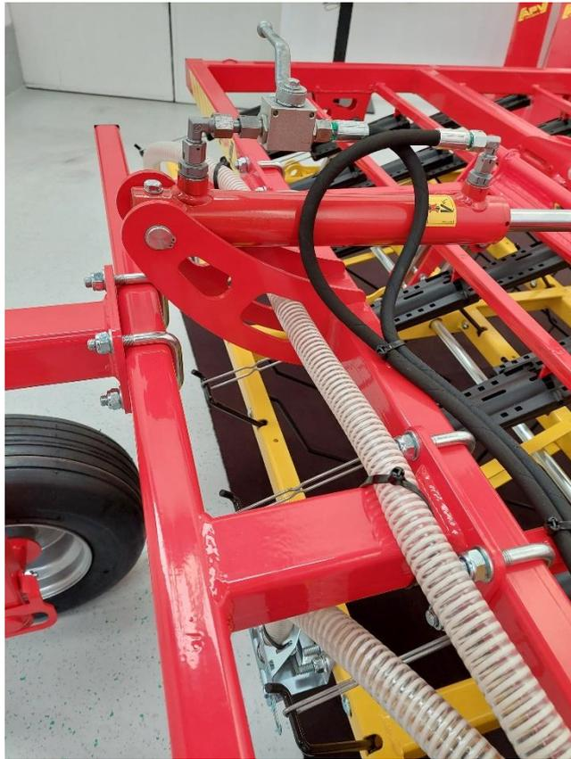
Figure 80 : pose des flexibles le long de la herse 7
