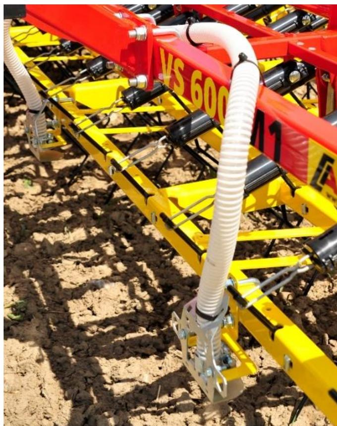
Figure 83 : pose des flexibles le long de la herse 10
