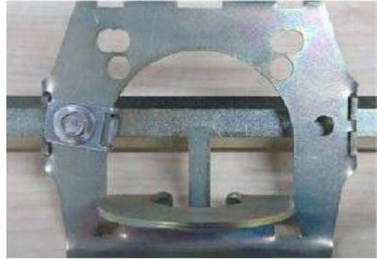
Figure 52 : déflecteur enfilé et fixé sur la barre hexagonale
