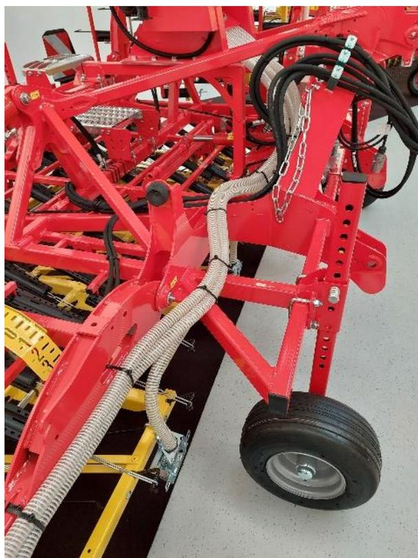
Figure 75 : pose des flexibles le long de la herse 2
