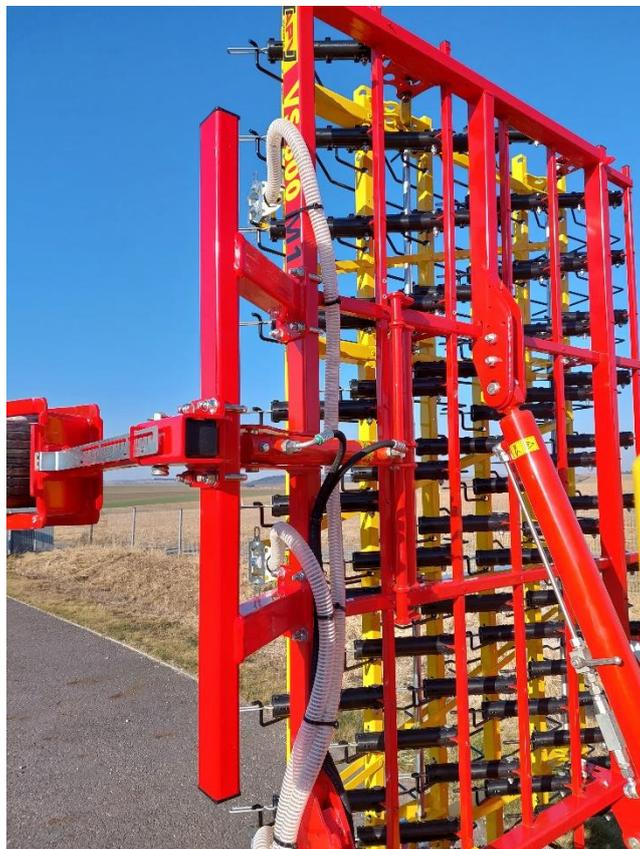
Figure 81 : pose des flexibles le long de la herse 8
