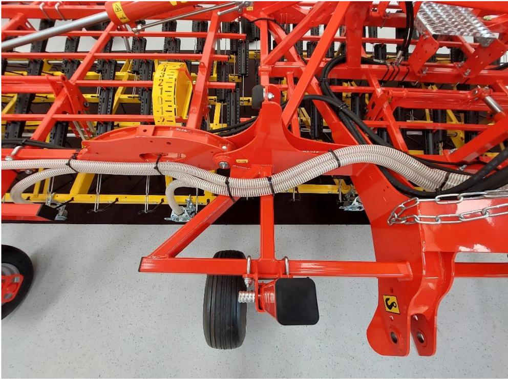
Figure 76 : pose des flexibles le long de la herse 3
