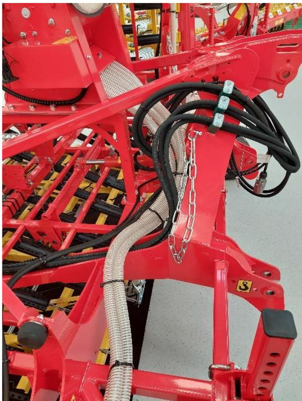
Figure 74 : pose des flexibles le long de la herse 1
