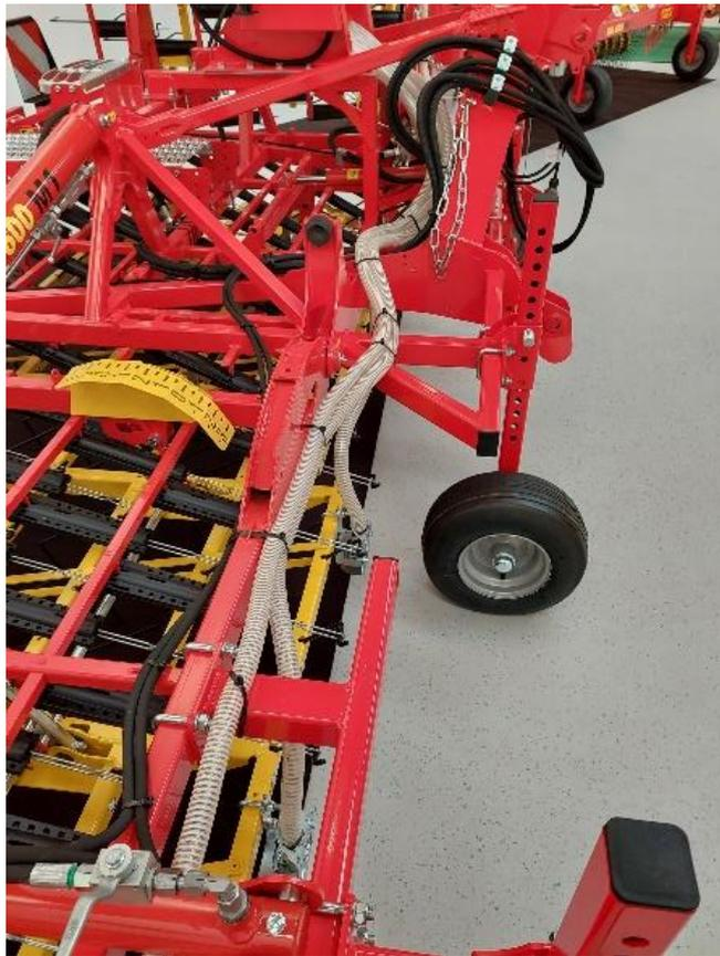
Figure 78 : pose des flexibles le long de la herse 5
