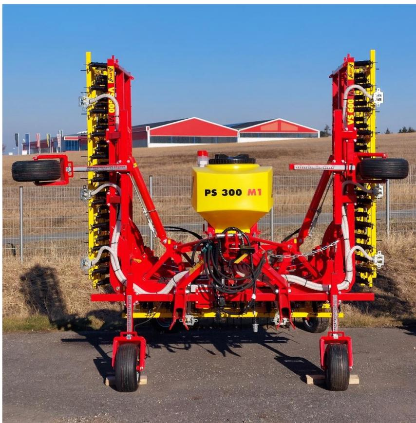
Figure 85 : VS600 avec PS à l'état replié
