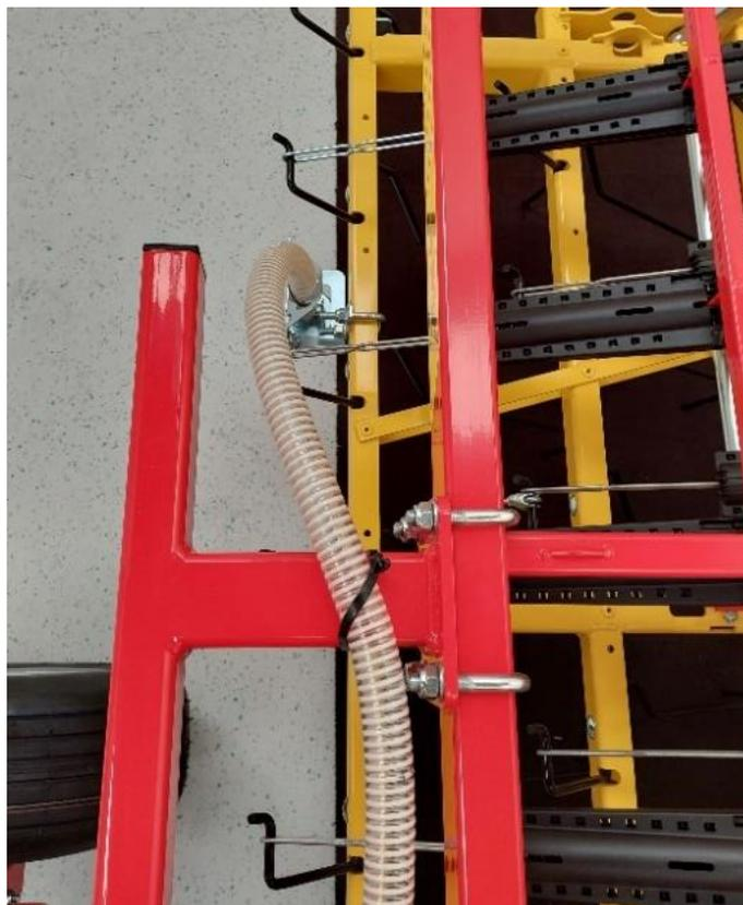
Figure 82 : pose des flexibles le long de la herse 9
