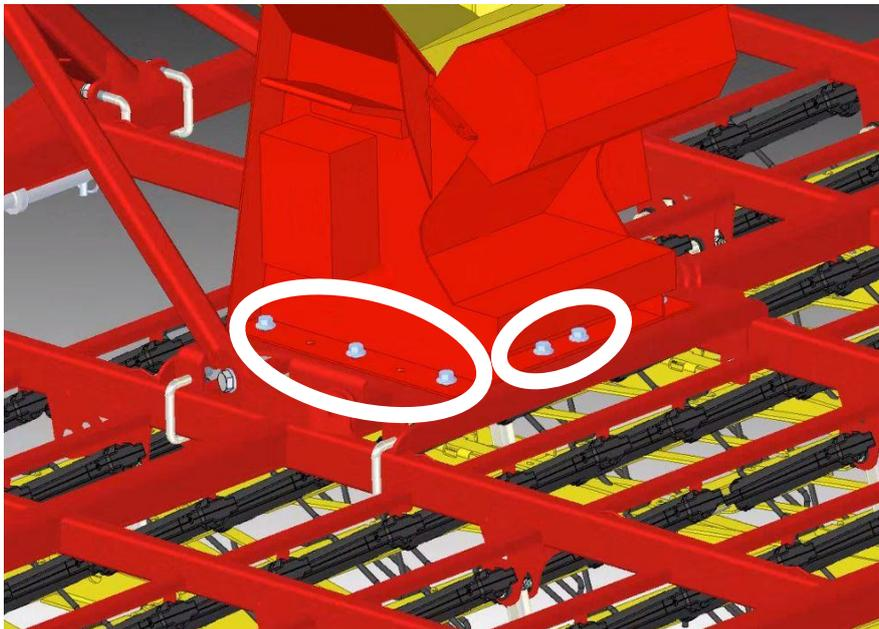
Figure 42 : fixation du PS sur le support à l'aide des vis six pans
