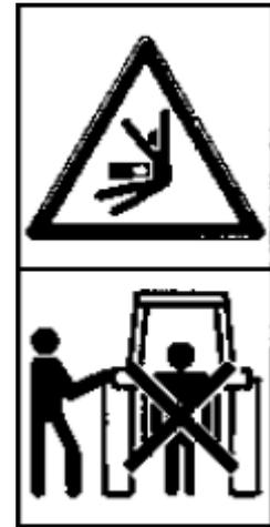
Ne pas monter sur des pièces en rotation ; utiliser les accès prévus !
