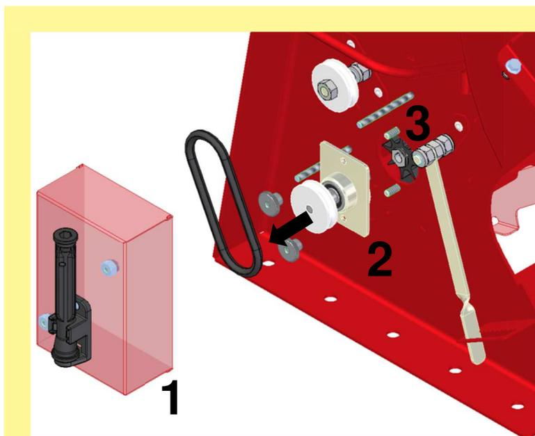
Abbildung 1: Demontage des Lagerflansches
