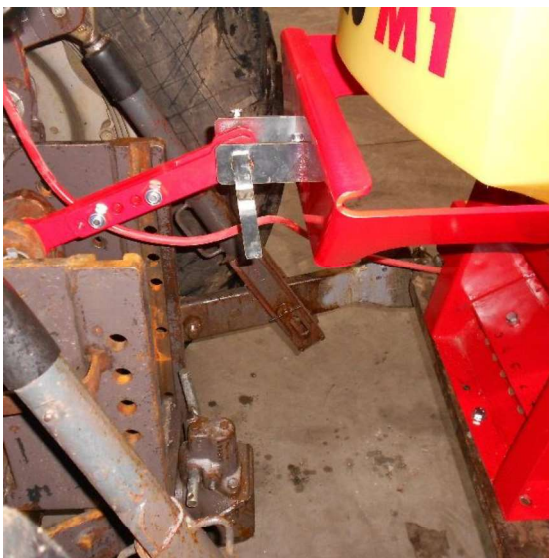
Abbildung 8: PS mittels Dreipunkthalterung am Traktor angebaut 1
