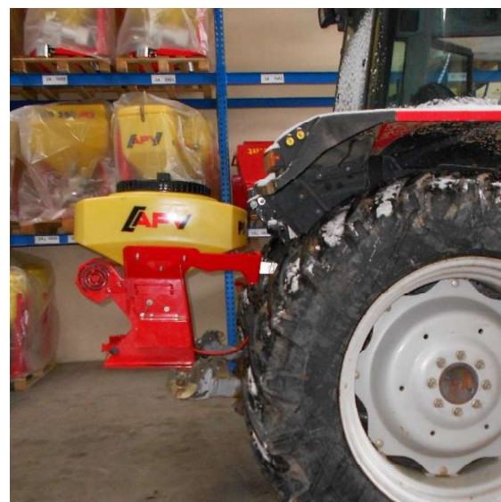
Abbildung 9: PS mittels Dreipunkthalterung am Traktor angebaut 2
