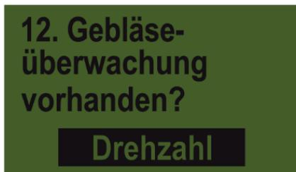
Ändern Sie den Punkt 12 mit den +/- Tasten auf „Drehzahl“.
