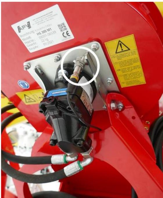
Bei aktuelleren Geräten sitzt die Verschluss-schraube in der Hydraulikmotorhalterung gleich neben dem Hydraulikmotor (Abbildung 2).
