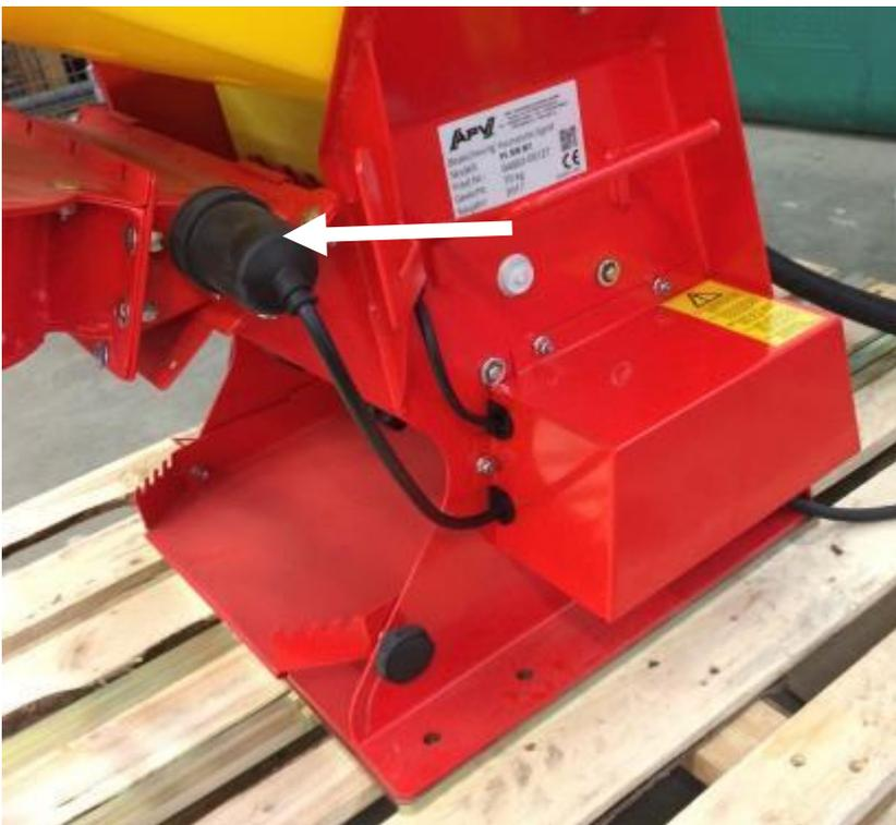
Der Druckschalter kann an dem PS verbaut bleiben. Schließen Sie den Druckschalter (Abbildung 4) an der Klemmleiste am PS (siehe Anschlussplan, Abbildung 6) ab. Ist kein Druckwächter verbaut, müssen Sie nichts verändern/tun.
