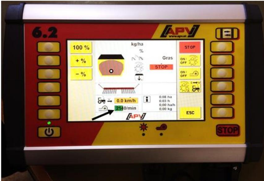
An der gekennzeichneten Stelle werden im Arbeitsmenü die Gebläseumdrehungen pro Minute angezeigt (Abbildung 30).
