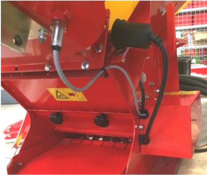
Verlegen Sie das Kabel, indem Sie es mit einem Kabelbinder am Gebläse befestigen. Führen Sie es dann durch die am Deckel vorhandene Kabeldurchführung. Der Deckel wird wieder mit den drei zuvor demontierten Muttern und der Schraube am Gerät befestigt (Abbildung 11).
