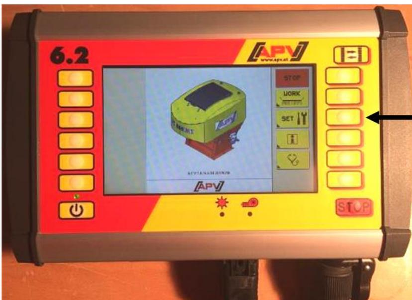
Drücken Sie im Hauptmenü des Steuermoduls die SET-Taste für 3 Sekunden bis Sie in das Untermenü gelangen (Abbildung 24).
