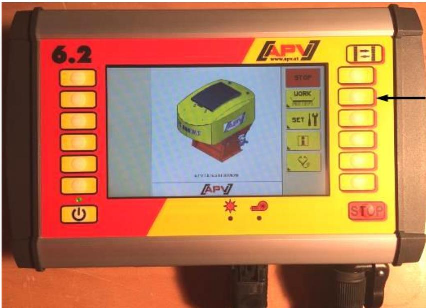
Steigen Sie mit der WORK-Taste in das Arbeitsmenü des Steuermoduls ein (Abbildung 29).
