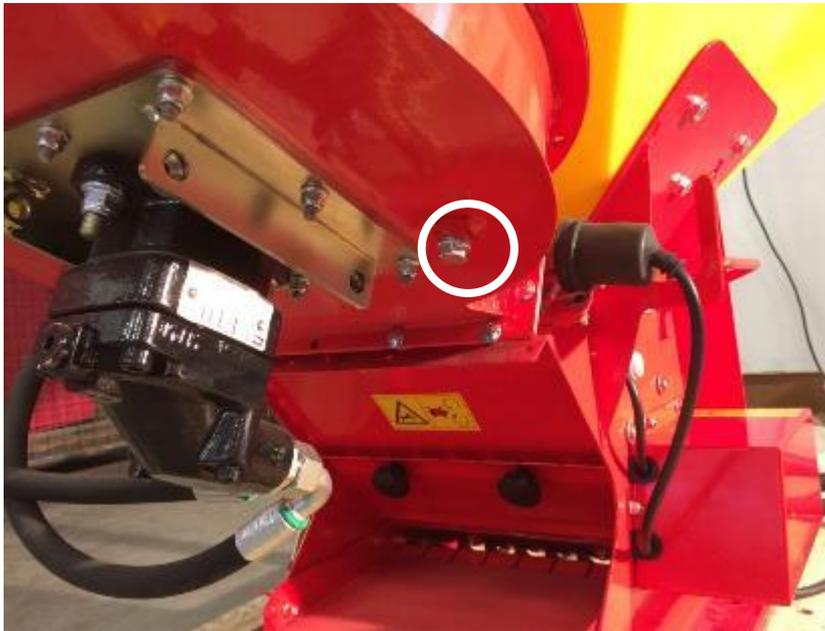
Demontieren Sie die gekennzeichnete Verschluss-schraube mit einem Gabel- oder Steckschlüssel SW 13 (Abbildung 1).
