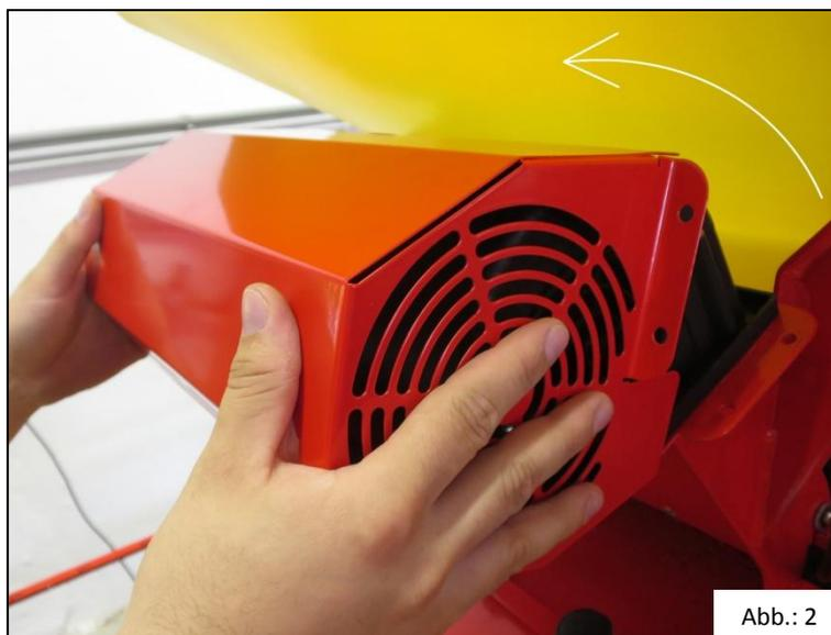
3. Nehmen Sie den oberen Teil des Strohschutzstutzens zur Hand und befestigen Sie diesen auf beiden Seiten mit den zuvor gelösten Schrauben am Stahlgestell.
