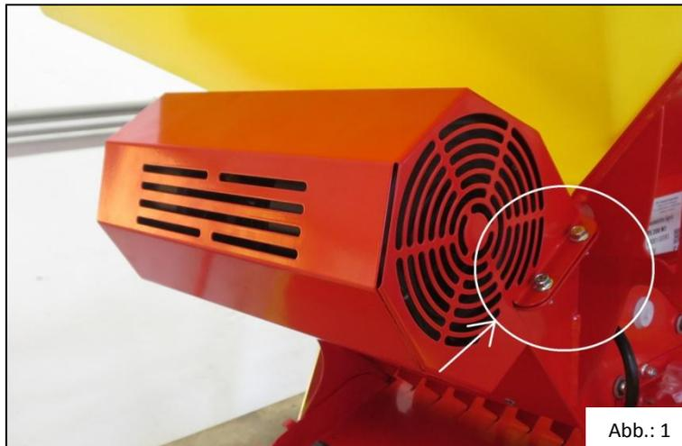
2. Drehen Sie die Gebläseabdeckung, wie in Abb. 2 mit dem Drehrichtungspfeil gekennzeichnet, nach vorne hinunter.
