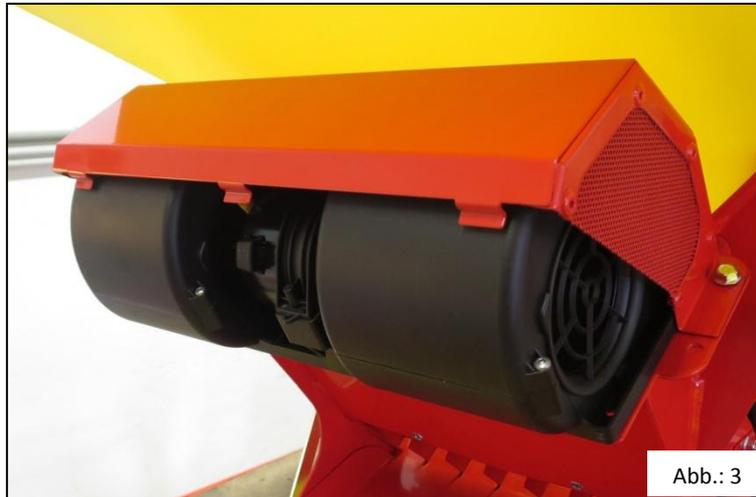
4. Befestigen Sie nun den unteren Teil des Strohschutzstutzens, indem Sie die 3 Langlöcher, welche sich auf der Oberseite dieses Teils befinden, nach oben hin in die in Abb. 3 sichtbaren Haken einfädeln.
