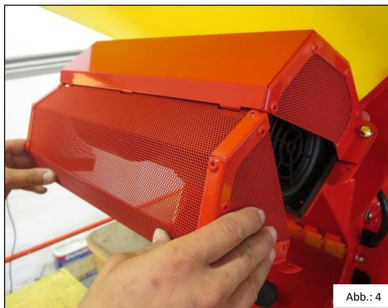
5. Positionieren Sie den zweiten Teil des Strohschutzstutzens so auf das Stahlgestell, damit sich die Bohrungen des Strohschutzstutzens und die des Stahlgestells überlappen. Befestigen Sie dieses Teil mit den zuvor gelösten Schrauben am Stahlgestell.
