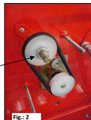
3. Fixez l'afficheur fourni sur l'arbre de l'agitateur (filet M10) (avec 2 clés de 17).
