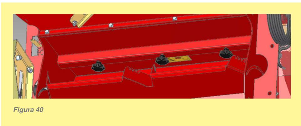
2. Suelte los dos tornillos de mango de estrella laterales de la lanzadera de corte y suba la lanzadera por los orificios longitudinales, de forma que quede posicionada entre los difusores de separación. A continuación, vuelva a fijarlos con los tornillos de mango de estrella (Figura 41).
