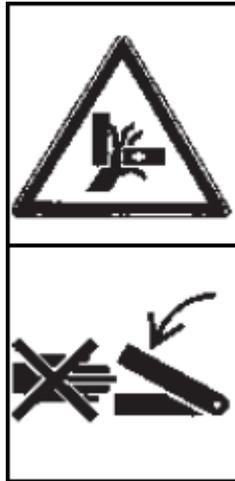
Beim Anhängen und beim Betätigen der Hydraulik darf niemand zwischen den Maschinen stehen!
