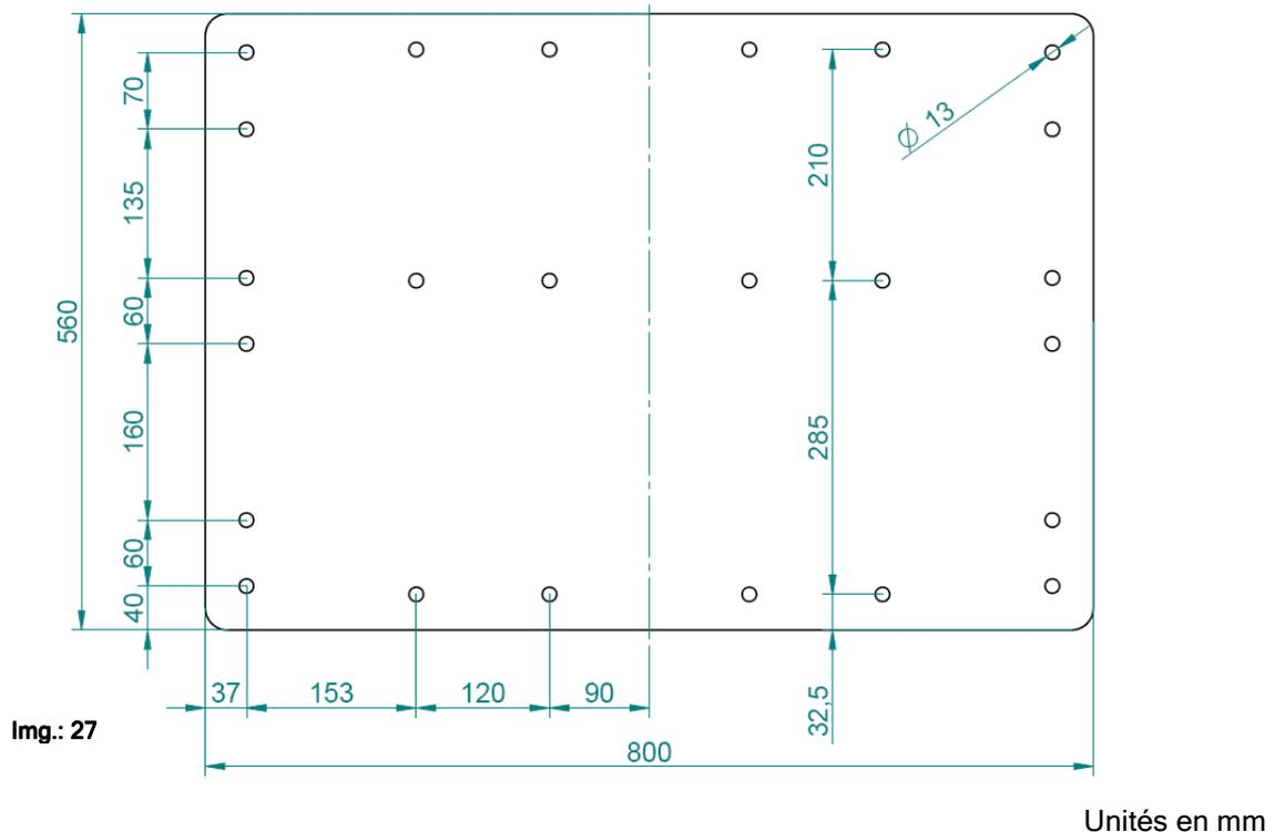
La surface au sol doit être de minimum 160 x 700 mm !
