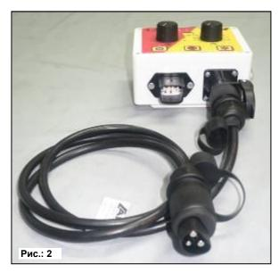
Кабель, входящий в комплект серийной поставки, можно подключить напрямую к стандартной 3-полюсной розетке трактора в кабине. Другой конец соедините с управляющим модулем.
