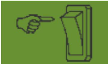
Haben Sie an Ihrer Maschine einen Abdrehschalter verbaut, und ist dieser im Programmiermenü (siehe Kapitel 0) auf JA gestellt, so kann damit auch der Behälter entleert werden. Die Säwelle dreht bei voller Drehzahl, solange man den Abdrehschalter gedrückt hält.
