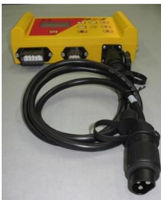
Schließen Sie das serienmäßig mitgelieferte Kabel direkt an die 3-polige Normsteckdose des Schleppers an. Das andere Ende verbinden Sie mit dem Steuermodul.
