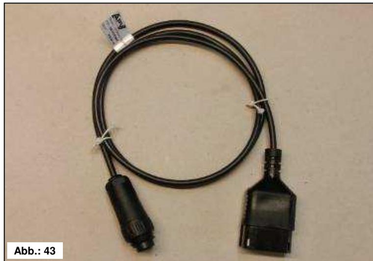
**Anschluss:** 12 poliger Stecker am Steuermodul
