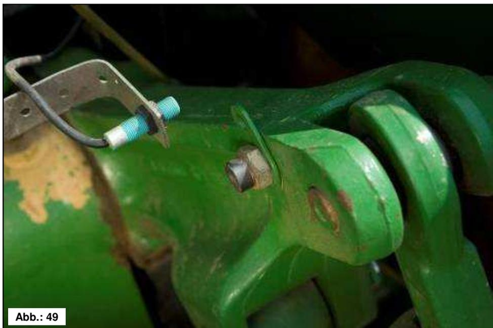
Die Säwelle des PS kann über diesen Sensor beim Anheben und Senken des Arbeitsgerätes automatisch losdrehen und stoppen.
