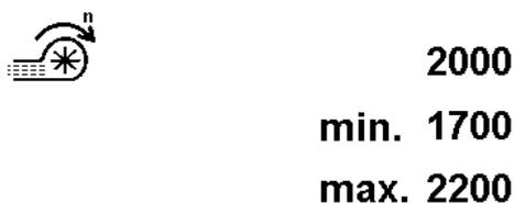
Hier können die Drehzahl und die Alarmgrenzen des hydraulischen Gebläses eingestellt werden.
