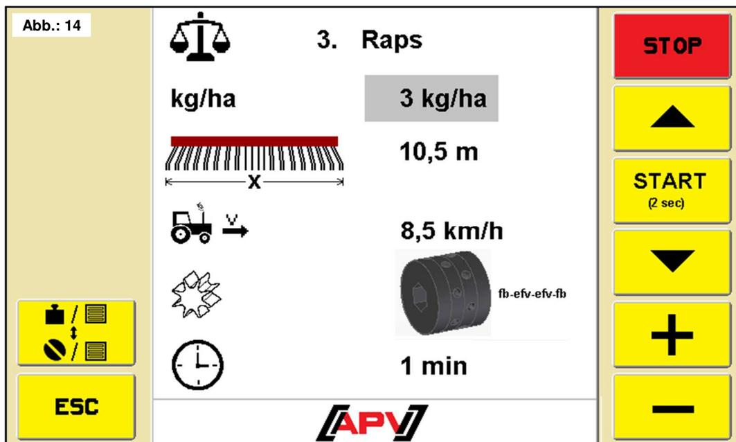
In diesem Menü werden die für die Abdrehprobe nötigen Parameter eingegeben.
