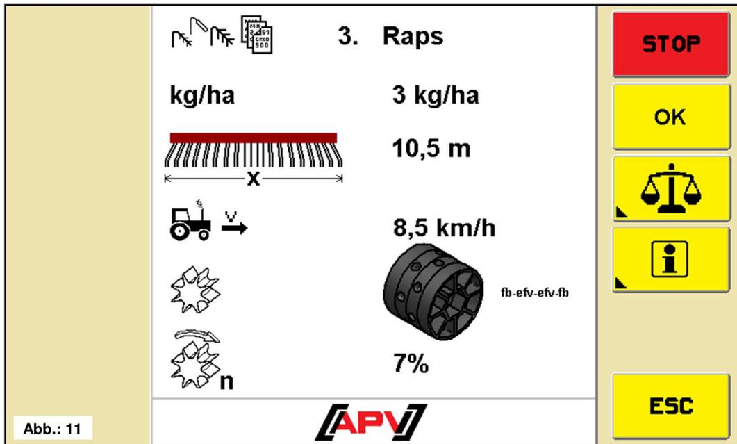
In diesem Menü werden alle eingestellten Parameter angezeigt, die bei der letztmaligen Anwendung des Saatguts gespeichert wurden.
